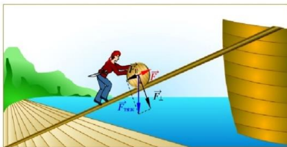
Использование наклонной плоскости для поднятия тяжелых грузов
