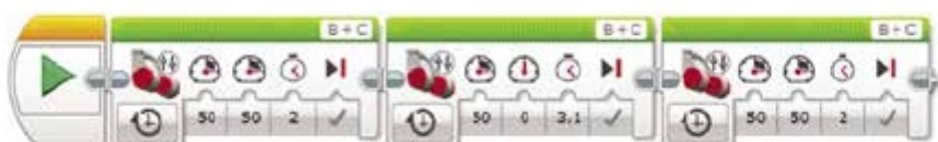
3.4.3-сурет. Моторларға жылдамдық мәнін 50 және 50 деп беру
