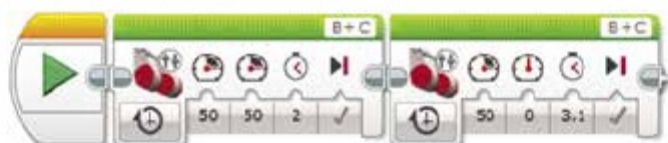
3.4.2-сурет. Моторларға жылдамдық мәнін 50 және 0 деп беру
