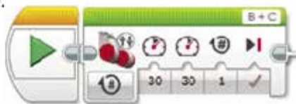
3.3.4-сурет. Гироскопиялық датчикті Моторды тәуелсіз басқаруға жалғау
